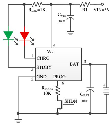
图 3 可信号控制充电电路
