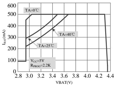
4.2V 充电电流与电源电压的关系曲线
